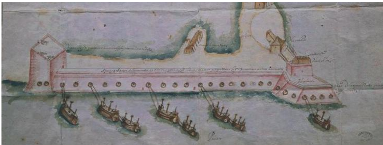
Muro de argollas de San Juan de Ulúa (Archivo General de Indias)
